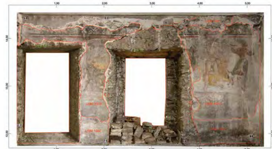
705 CF III, interno nord: fotopiano con analisi stratigrafica. Rilievo e restituzione grafica: R. Benedetti, F. Casale, I. Zamboni
