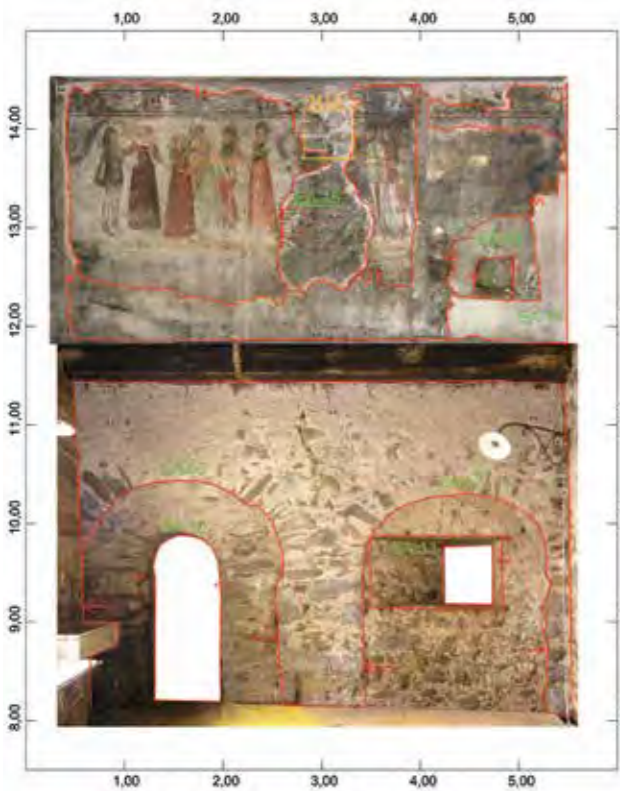
704 CF III, interno ovest: fotopiano con analisi stratigrafica. Rilievo e restituzione grafica: R. Benedetti, F. Casale, I. Zamboni
