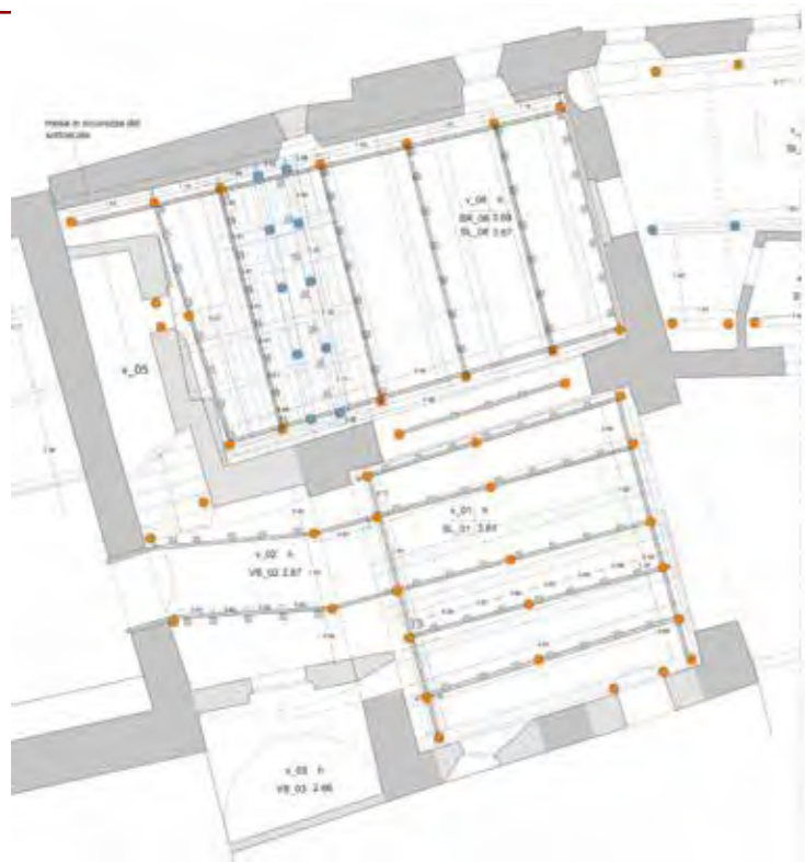
715-716 Progetto di messa in sicurezza e realizzazione di un presidio a contrastare il possibile meccanismo di ribaltamento della facciata
